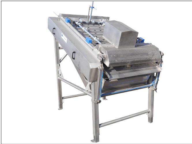
耙式系统可气动升降，将贻贝分离后通过机器输送。这使得除须机便于清洁和维护，以及保证较高的处理量！
