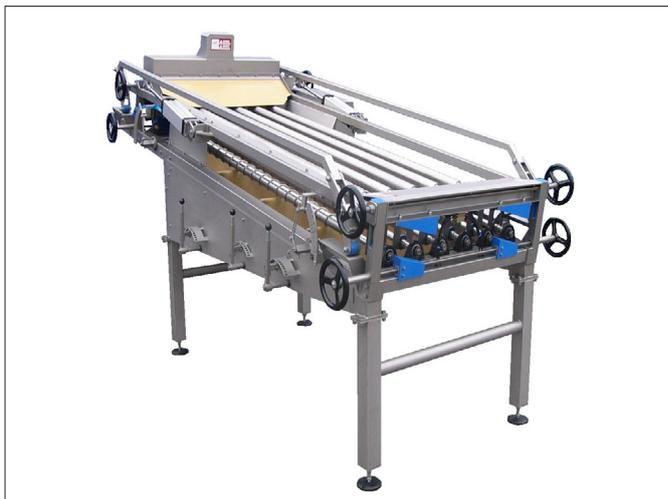
Le principe de la trieuse de moules est basé sur des rouleaux tournants munis d'une spirale, de sorte que les moules puissent être transportées 1 par 1 par l'intermédiaire de cette spirale. Tous les rouleaux sont entraînés par 1 moteur et la machine peut être ajustée à partir de tous les angles.
