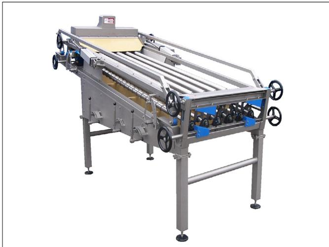
贻贝分拣机采用转辊运行。这些转辊为螺旋形，可确保逐一输送贻贝。所有转辊由一台电机供电，并将机器设定为所有角度。
