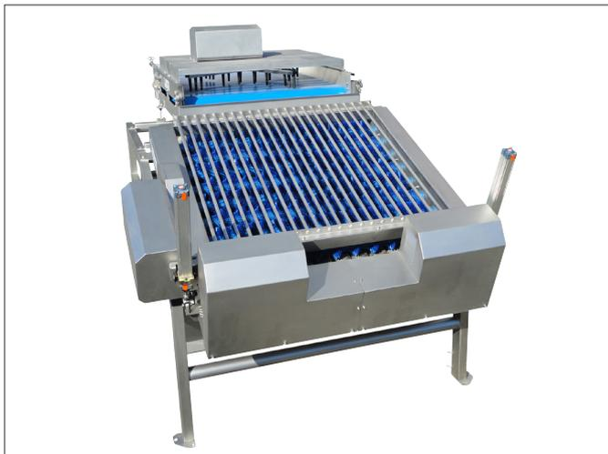
La brosseuse de moules manipule les moules avec le plus grand soin tandis qu'elle élimine l'encrassement des coquilles. Cela signifie que l'endommagement des coquilles est maintenu à un minimum absolu et que le bleu dit « d'usure » n'apparaît pas sur les coquilles.
