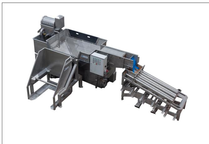
Le principe de la trieuse de universel est basé sur des rouleaux tournants ; la machine se compose de jeux de 2 rouleaux : Un rouleau est muni d'une spirale, l'autre est un rouleau lisse ; ensemble, ils assurent le transport des bulots, un par un. Tous les rouleaux sont entraînés individuellement par un tambour-moteur.
