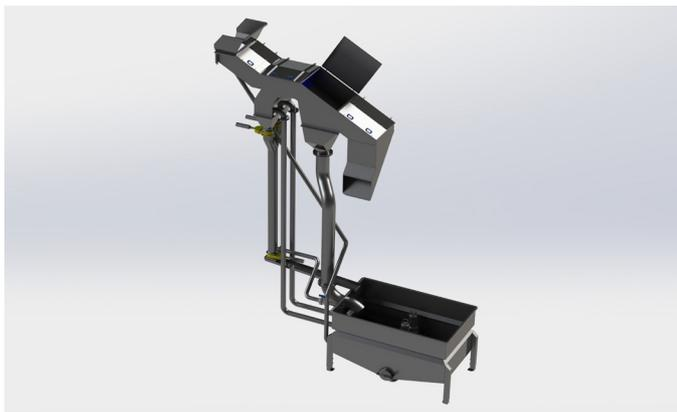
Un autre avantage est que le capteur de pierres a également un effet de lavage sur le produit.
