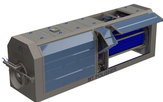
Une courroie robuste a été choisie pour faire tourner le tambour. Le tambour est soutenu par des rouleaux. Les rouleaux de brosses tournent grâce à des courroies trapézoïdales et sont équipés de roulements à billes. Notre conception garantit également une distance maximale de 3 mm entre les rouleaux de brosses, ce qui permet de minimiser les pertes de produit.
