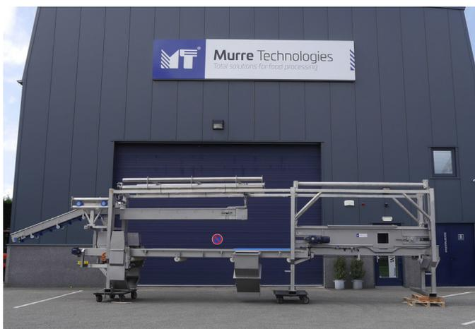
Les entraînements sont assurés par des tambours et des moteurs à glissement, et les roulements sont des paliers robustes, remplis de graisse pour les aliments.
