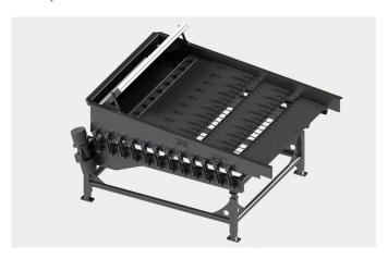
La machine est entraînée indirectement par 2 moteurs à balourds et est équipée d'une section d'alimentation permettant de répartir efficacement le produit sur toute la largeur de la table de triage, après quoi les carottes sont positionnées dans le sens de la longueur au moyen de plaques de guidage à rail en V. Deux ouvertures réglables en continu sont montées dans le sens longitudinal pour permettre le tri sur deux tailles de fond différentes.
